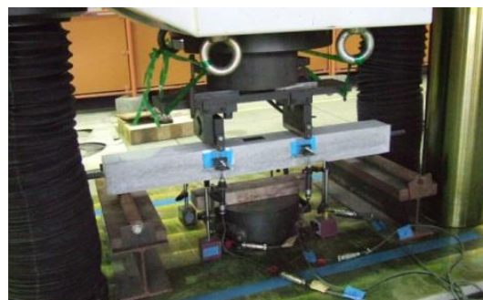
写真 - 8 曲げひび割れ幅抑制試験状況
