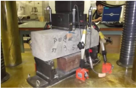
写真 - 2 曲げ性能試験実施状況
