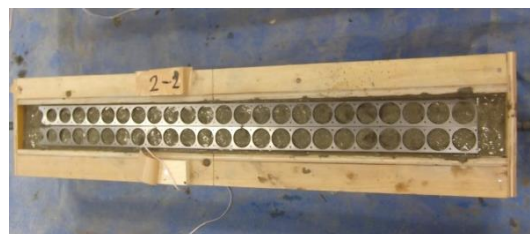
写真 - 7 曲げひび割れ幅抑制試験体製作状況 (ハイグリップ・メタルバンド, 穴並列)
