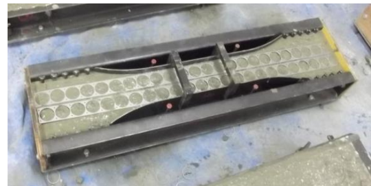
写真 - 3 ひび割れ抵抗性試験、試験体製作状況 （上下面から 20mm の位置にハイグリッパ・メタルバンド 1 列ものを並列に設置）
