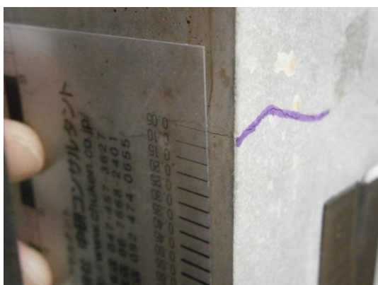
写真 - 6 ひび割れ幅 (4 週経過後, ハイグリップ・メタルバンド : 0.05mm)
