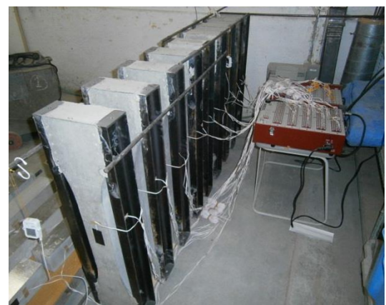
写真 - 4 ひび割れ抵抗性試験実施状況
