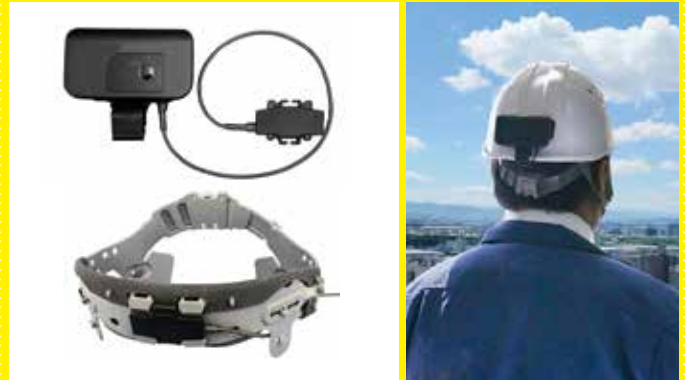
左上: デバイス本体 | 左下: センサ測定部(ヘルメット内バンド) | 右: 装着状況
