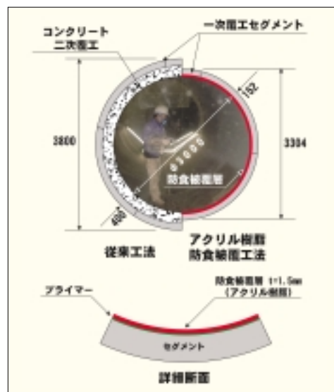
アクリル樹脂防食被覆工法
