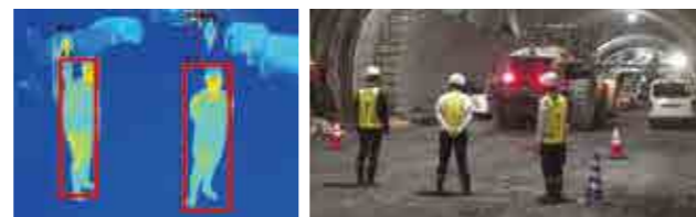
遠赤外線カメラでの撮影事例 トンネル現場での検証状況
