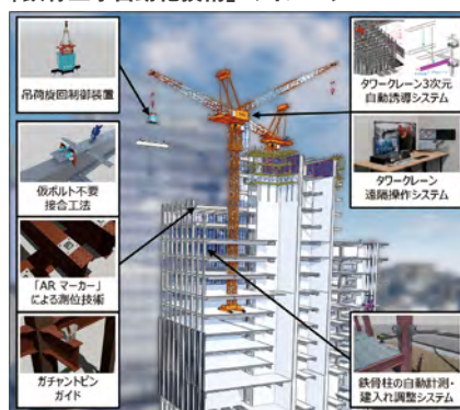
「鉄骨工事自動化技術」のイメージ
