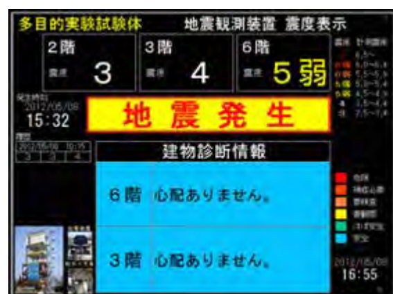
震度・建物健全性診断画面の表示例
