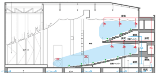
クールヒートレンチを利用した空調方式（講堂）
