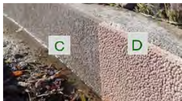
C: 改良パネルの表層に凹凸を加工(右)、 D: 従来の発泡セラミックスパネル(左)
