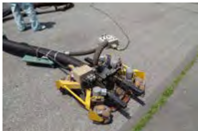
バキュームブラストロボットシステム
