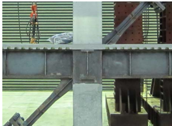
写真2 性能確認構造実験（ブレース付き架構）
