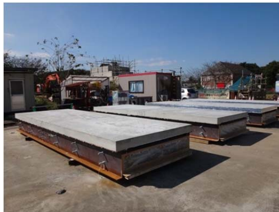
実大デッキスラブ試験体
