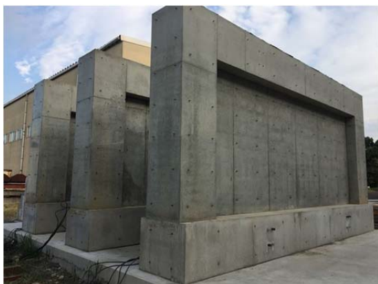
実大壁試験体
