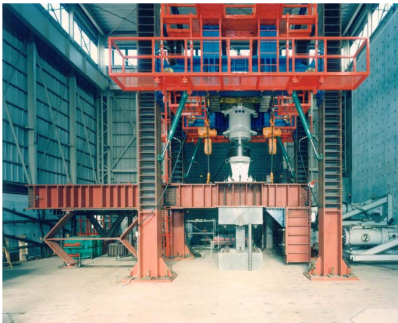
図1 超高強度RC柱の構造実験
