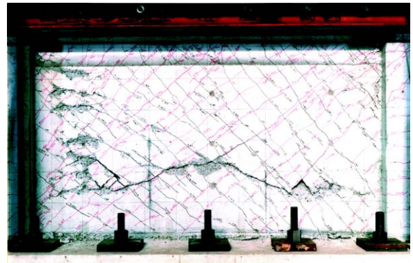
写真 - 2 . W Z - 0 1 試験体破壊状況
