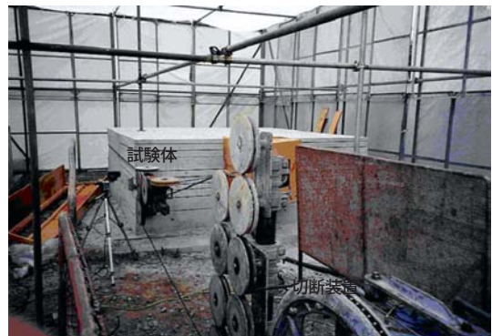
図 - 3.7 切断試験状況
