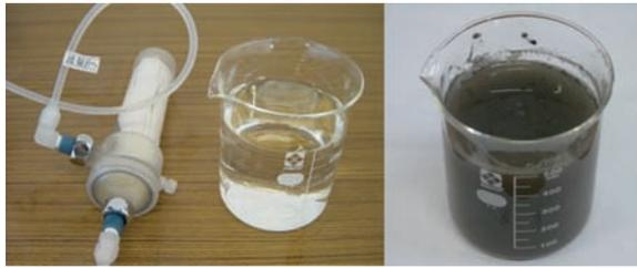
写真-7 (左) 限外ろ過膜と処理水 (右) 原水
