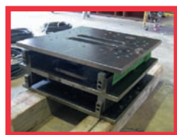
(a) 2層化免震外観
