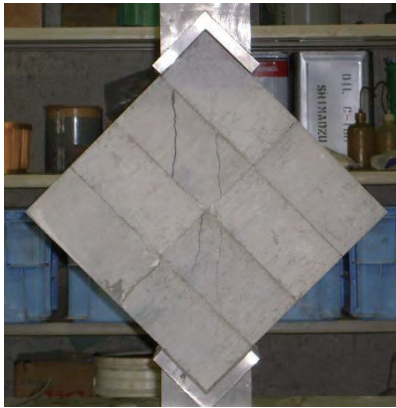
図-11 ひび割れ発生状況
