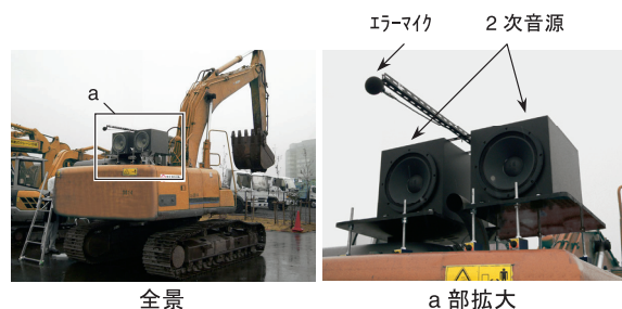
写真-1 2次音源およびエラーマイク設置状況（実験1）
