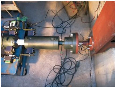
図-7 オイルダンパー設置状況
