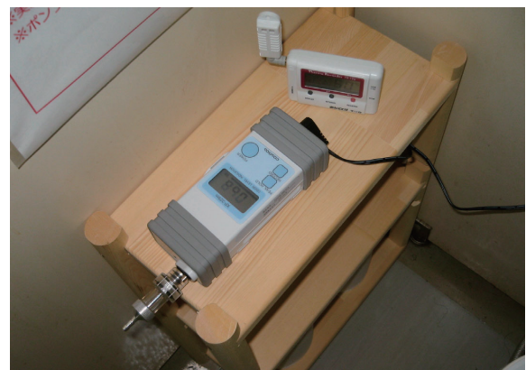
写真-2 おいセンサーによる測定状況
