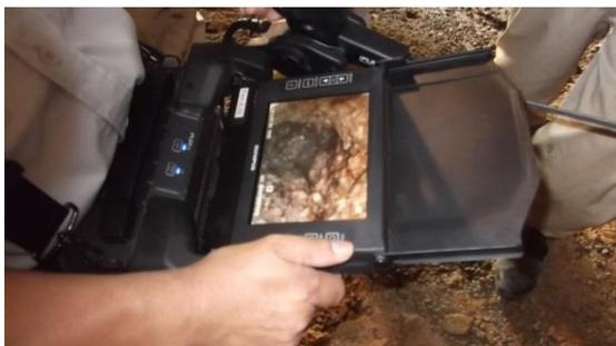
写真-2 孔内観察画像のモニター表示の一例
