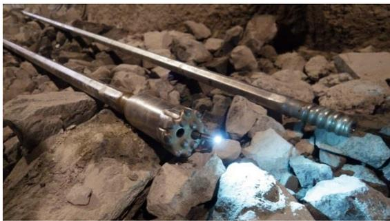
写真-1 ビットから突出した光学アダプター（φ8.5）
