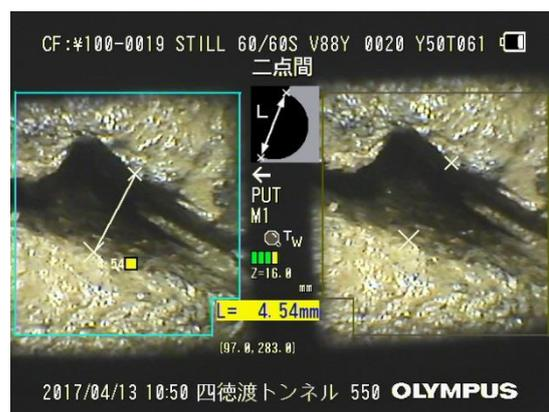
写真 - 10 開口割れ目の間隔測定状況 (W=4.54mm)
